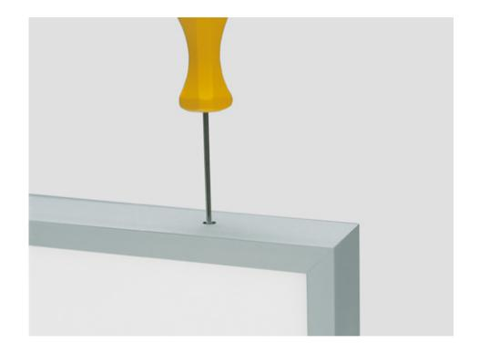
Der Profilrahmen wird durch das Eindrehen der vier Schrauben oben und unten am Profilrahmen mit dem Grundelement verschraubt und so gesichert. Die Schrauben stets bündig mit dem Profil eindrehen.
